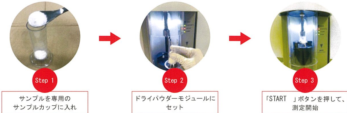
図2. LS 13 320 XR による乾式測定手順 (サンプル充填~サンプルセッティング~測定)
